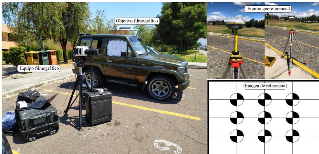
**Figura 22.** Equipo necesario para efectuar el ensayo de calibración
