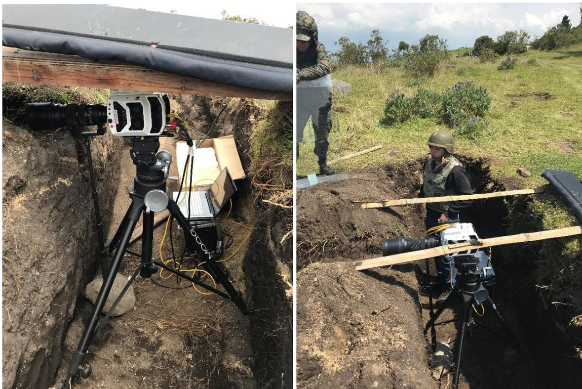
**Figura 37.** Fosa de protección del equipo filmográfico
