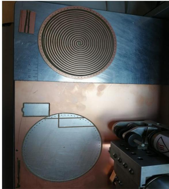
*Figura 44.* Corte Antena Espiral
