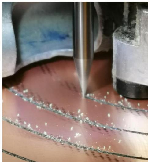
*Figura 42.* Corte del Substrato con la broca de la prototipadora
