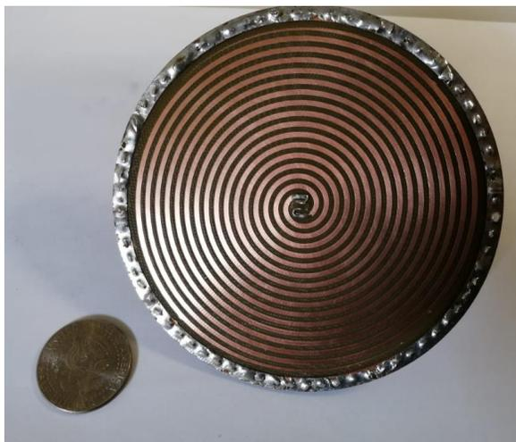
**Figura 46.** Diseño final de la antena espiral de Arquímedes
