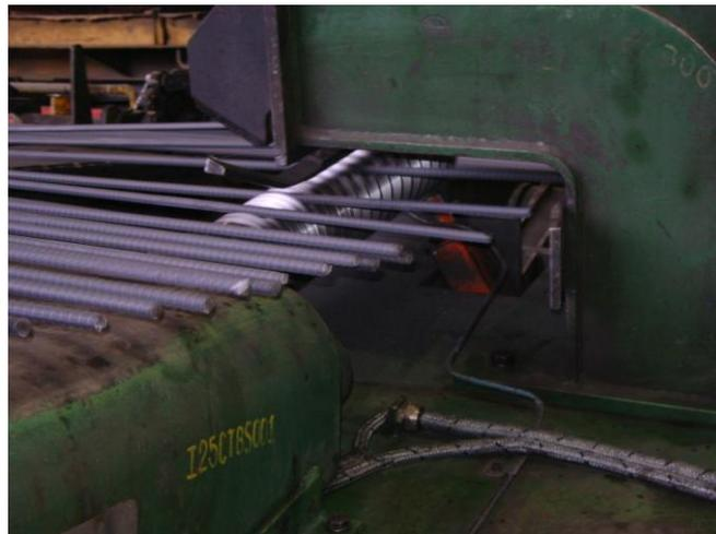
Figura 3.1. Separador de varillas mediante tornillo sin-fin
