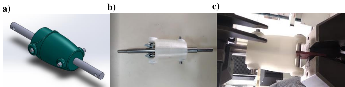
Figura 22. a) Diseño CAD de ensamblaje para ensayo de tracción, b) ensamblaje real, c) montaje en la máquina universal de ensayos
