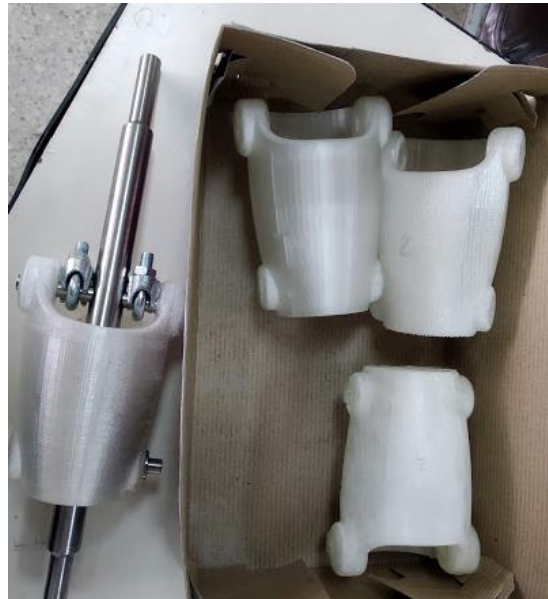
Figura 20. Prótesis fabricadas mediante M.A. para ensayo de tracción
