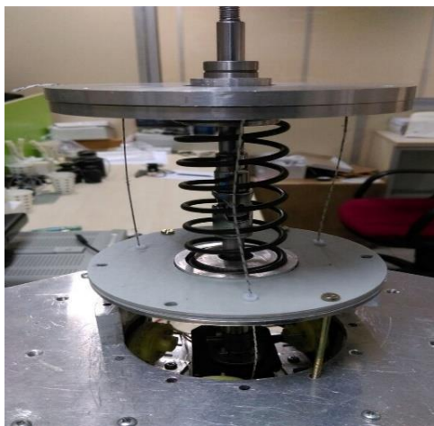
Figura 18. Prototipo de mecanismo Cuello Resorte
