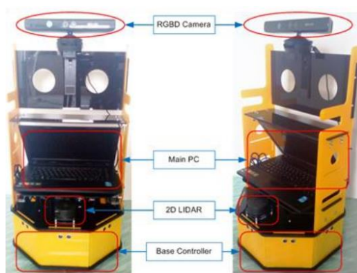
Figura 1. Robot de asistencia para seguir personas Fuente: (G. Priyandoko, Choi Kah Wei & M.Hendriyawan, 2018)
