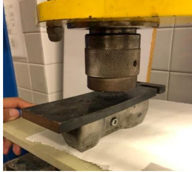
Figura 3.10 Fabricación de probetas para ensayo de tensión
