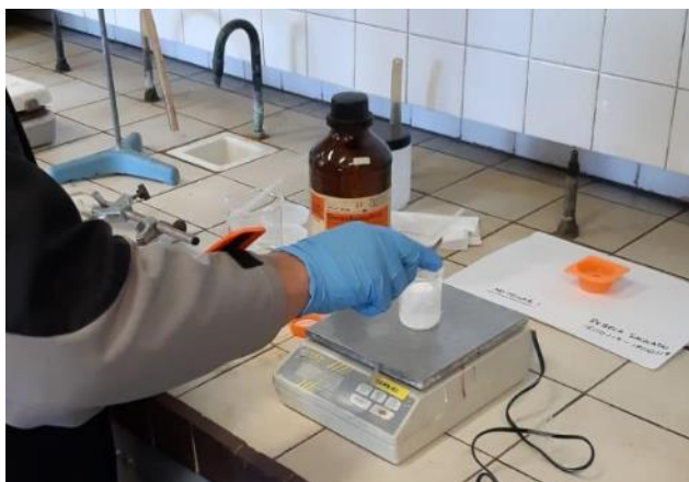
Figura 3.5 Forma de añadir el PAN en el DMF
