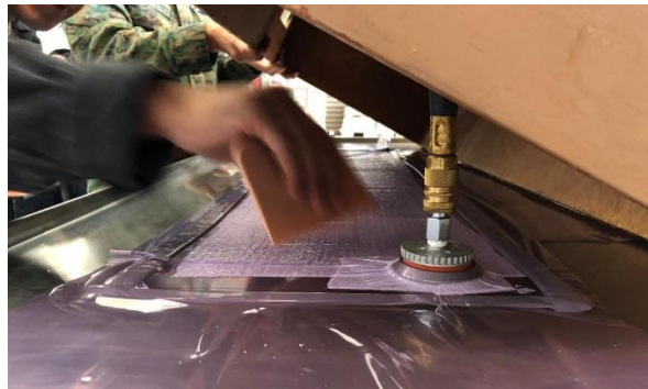
Figura 3.27 Verificación de fugas al realizar el vacío
