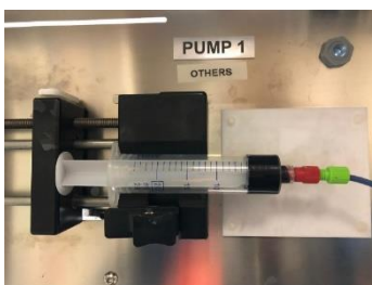
Figura 3.18 Proceso de PAN al 12% con MWNT al 0,1%
