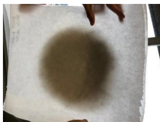
Figura 3.19 Proceso con PAN al 12%; MWCNT al 0,2%; con flujo de 1ml/h y distancia de 18cm
