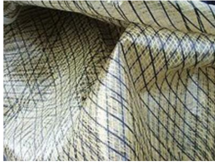
Figura 2.3 Vela para embarcaciones de tejido laminado de Kevlar y fibra de carbono Fuente: Estudio de materiales compuestos, 2010
