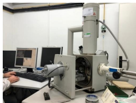
Figura 3.14 Ubicación de las muestras en la recámara del SEM
