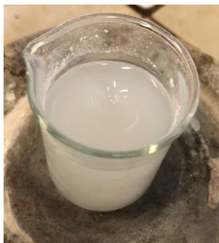
Figura 3.6 Mezcla de PAN 6% (1,8gr) con DMF (28,2gr)
