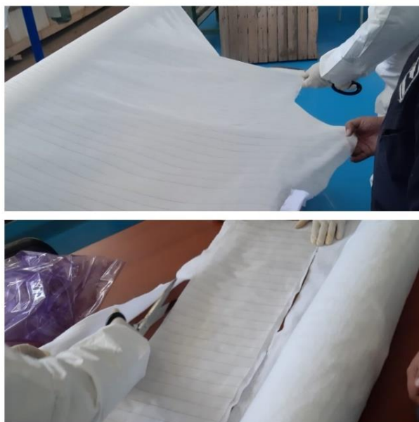
Figura 3.24 Corte del Peel Ply y el Breather
