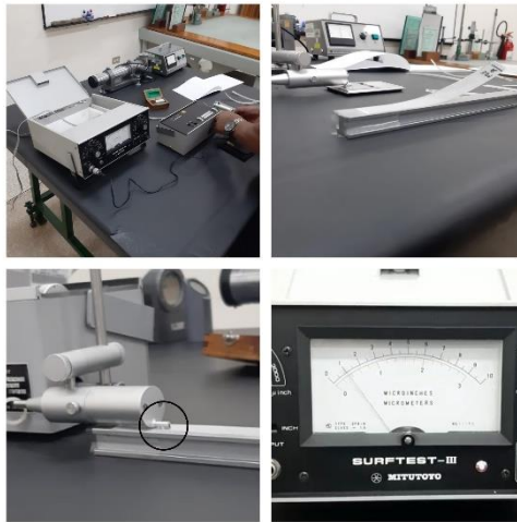
Figura 3.32 Procedimiento de medición en el rugosímetro
