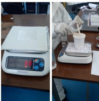
Figura 3.25 Determinación de peso de la fibra de vidrio y la resina
