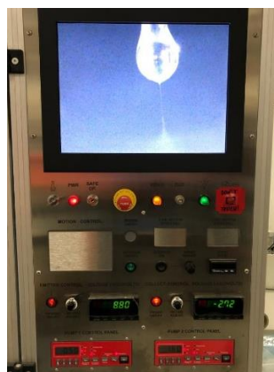
Figura 3.8 Proceso con PAN al 8%, con flujo de 0,5ml/h y distancia de 16,5cm
