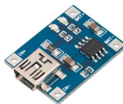
Figura 11 Módulo de carga de Batería Fuente. (NanJing, 2017)
