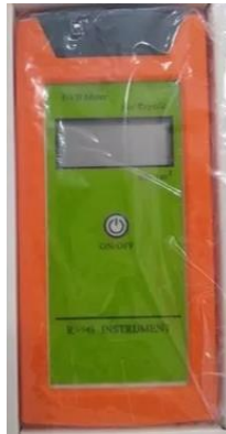
Figura 8 Medidor de mano de Radiación UV Fuente (Ponpe, 2018)
