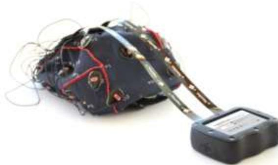
**Figura 31** Casco g.Nautilus g.tec
