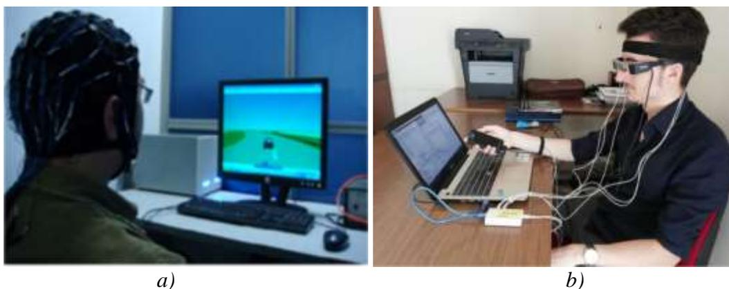
**Figura 1.** a) Control de BCI de un coche en entornos de realidad virtual 3D b) sistema AR-BCI
