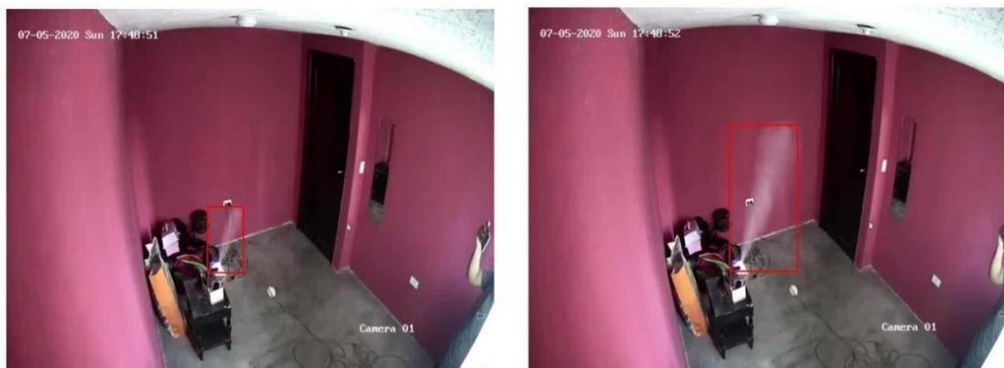
Posteriormente se genera una señal sonora que alerte de la presencia de humo inmediatamente después de que se encierre el área en la imagen, terminando así el proceso de detección.
