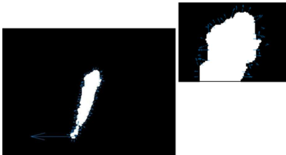
Las flechas que aparecen figura de la imagen binaria, denotan los vectores de velocidad de cada pixel. Se utiliza los componentes de estos vectores para identificar los ángulos de elevación presentes en la imagen y posteriormente se calcula una media de todos estos, con el fin de obtener una dirección estimada de su movimiento en grados.
