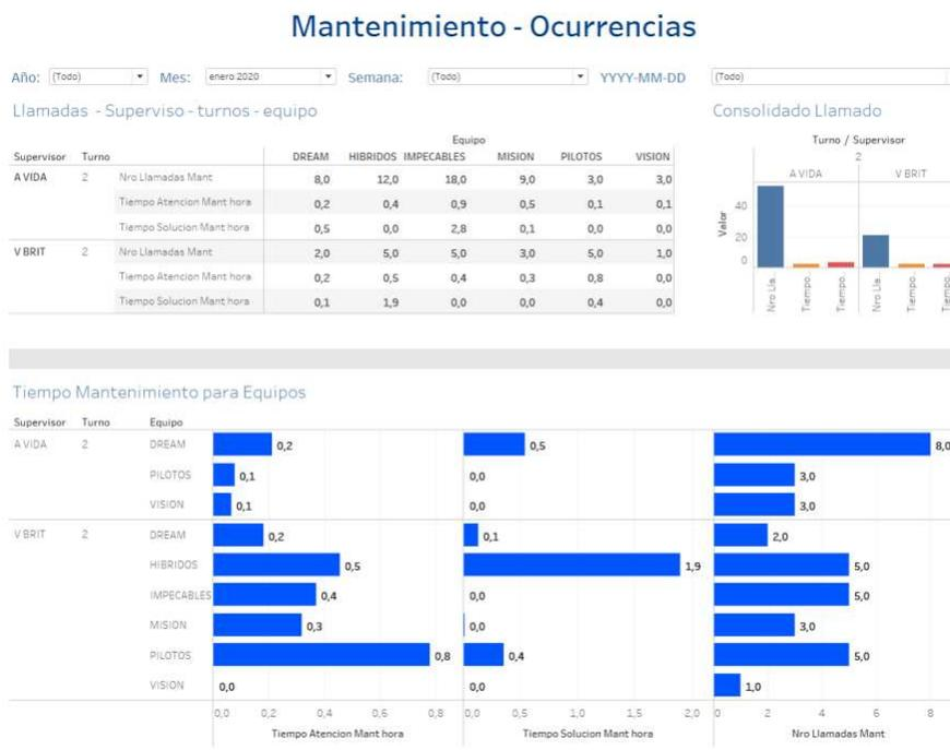
*Nota.* La figura muestra un dashboard creado en la herramienta Tableau que muestra las paras de la planta por llamados a mantenimiento, por problemas de la máquina.
