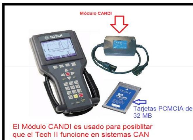
**Figura 19.** Protocolo J2534 con modulo CAN.
