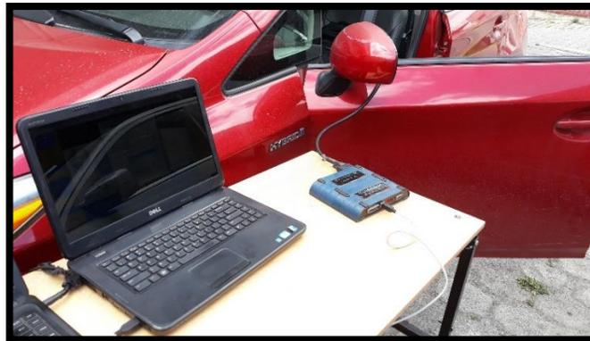
**Figura 23.** Conexión PC, vehículo y la interfaz.
