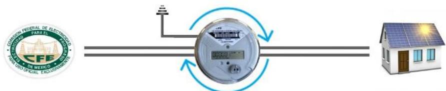
**Figura 15.** Medidor bidireccional
