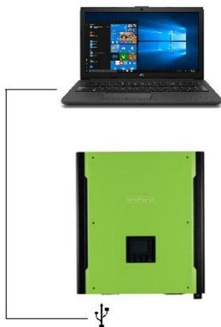
**Figura 31.** Conexión entre el inversor y el ordenador
