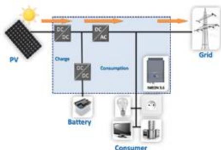
El inversor Híbrido utiliza la energía generada en los paneles para inyectarla a la red eléctrica o a otros consumos.
