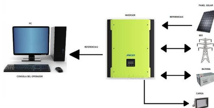
**Figura 16.** Esquema de un sistema de monitoreo
