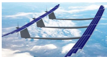
Figura 26. UAV solar ApusDuo – HAPS Fuente: (Sam Davis, 2018)
