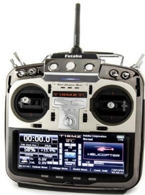
Figura 110. Transmisor Futaba 18MZ Fuente: (FutabaUSA, s. f.)
