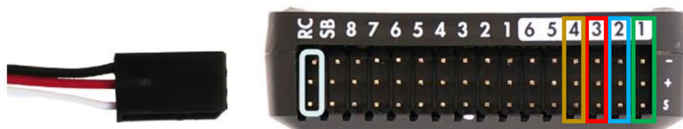
Figura 116. Conexión receptor – Pixhawk
