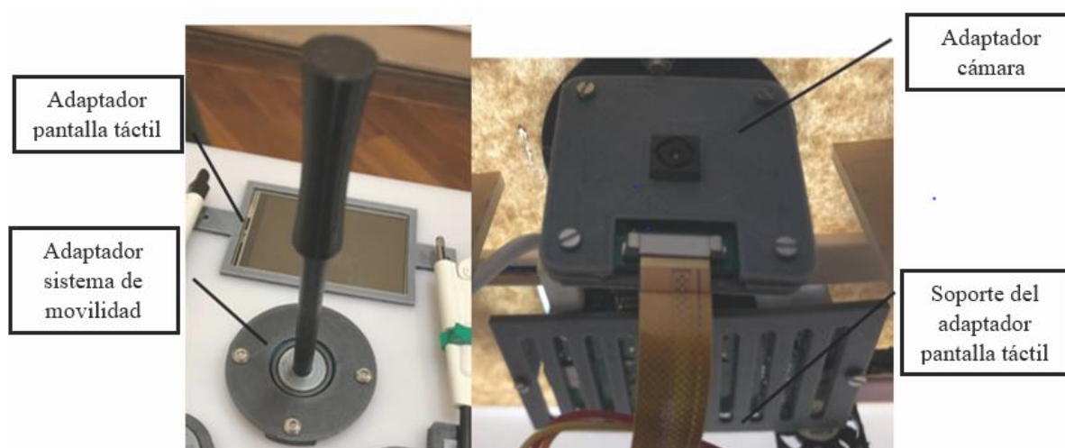
Figura 44. Ensamble del sistema de movilidad de la cámara y el adaptador de la pantalla
