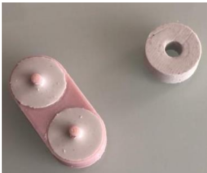
Figura 42. Molde de caucho silicona
