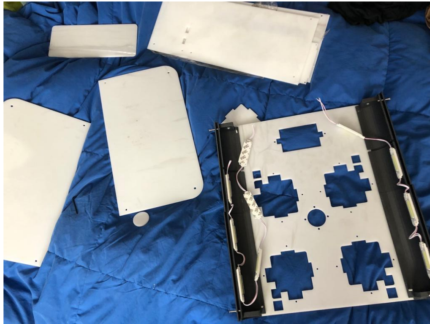
Figura 41. Elementos realizados en corte láser
