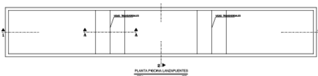
Vigas transversales en la piscina lanzapuentes
