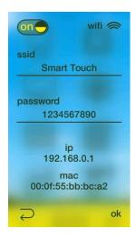
Nota. La Figura indica cómo crear una red local con la botonera Smart touch. Tomado de Manual de Usuario Smart Touch por Ingenium S.L, 2019.
