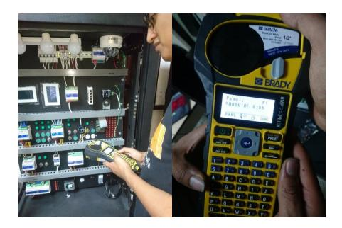
Nota. La figura indica la etiquetadora en la cual se registrarán todos los nombres y nomenclatura para los terminales del cableado y de los equipos del sistema de entrenamiento de domótica.
