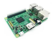
Nota. La Figura indica el controlador externo Raspberry. Tomado de Raspberry Pi 3 Model B+, análisis: más potencia y mejor Wifi para un mini PC que sigue asombrando por Xataka, 2018.
