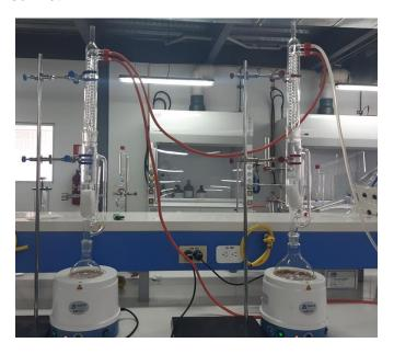
Terminado el proceso de desengrasado se procedió a realizar una serie de rota evaporaciones, con motivo de recuperar el disolvente utilizado en la extracción y determinar el peso de las sustancias que se extrajeron en dicho disolvente, así como se muestra en la figura 12.
