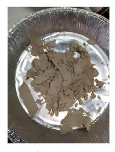
Posteriormente se secó el aislado proteico a través de una estufa de vació como se indica en la figura 21 con el fin de eliminar la humedad presente en la muestra.
