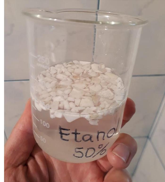
Figura 5. PP flotando en etanol
