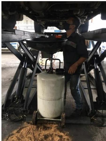
*Nota.* En otras lubricadoras se observó que utilizaban tierra como material oleofílico.
