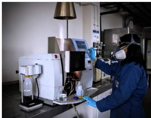
*Nota.* Equipo de espectrometría de absorción atómica a la llama empleado para el análisis de metales Fe, Cu y Al.
