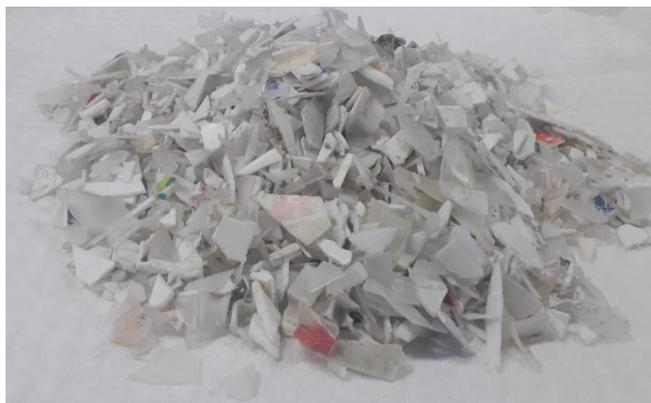
El código de la resina de polipropileno es colocado por el fabricante generalmente en su envoltura y en ocasiones en el producto; lo que dificulta la identificación de la resina que conforma el plástico, por lo que es necesario caracterizarlo mediante métodos como la Espectroscopia de Infrarrojo (FT-IR) y Calorimetría Diferencial de Barrido (DSC).
