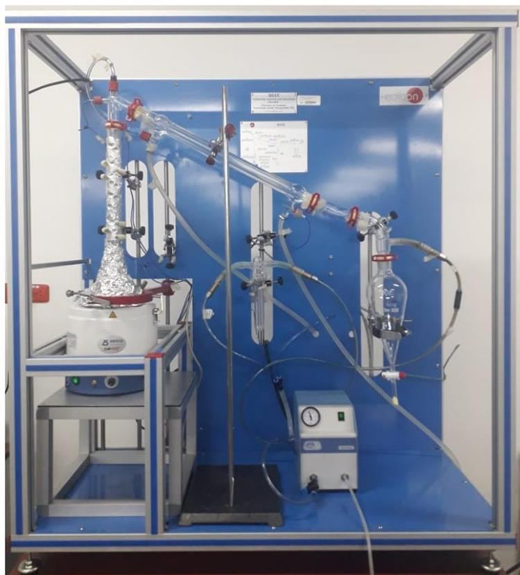
La Columna de Craqueo controlada por computador QCC es empleada para el estudio de los parámetros de reacción de la pirólisis catalítica según el diseño experimental propuesto. El equipo que se muestra en la figura 18 tiene las siguientes características:
