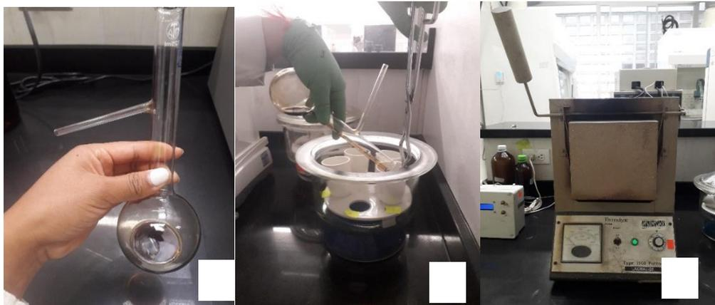
a) Residuo de la destilación ASTM D-86, b) Colocación de la muestra en los crisoles, y c) Mufra utilizada para el análisis.
