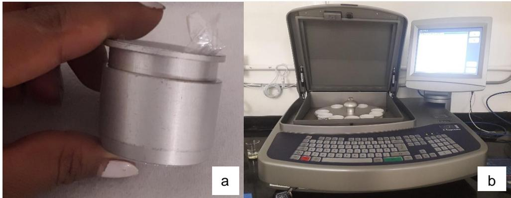
*a)Celda con la muestra de gasolina y b) equipo de análisis de azufre.*
