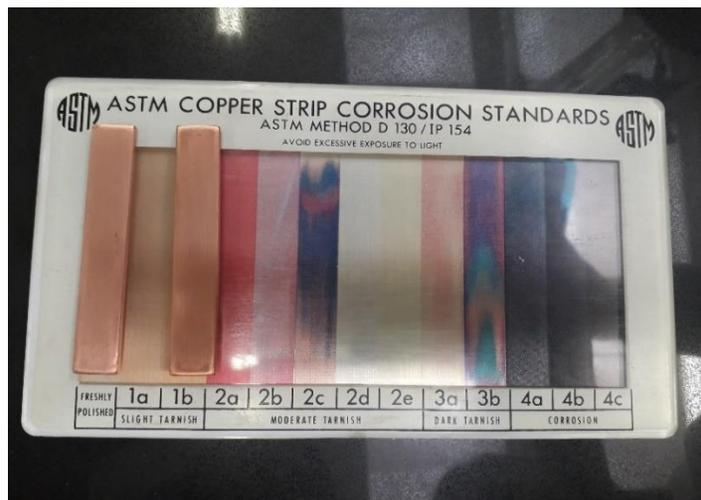
*Lámina de cobre de la gasolina (izquierda) y lámina de cobre del diésel (derecha).*
