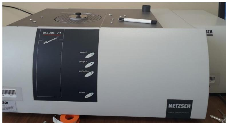
Se pesó 14.38 mg de la muestra, la misma que fue colocada en una celda de aluminio y luego fue sellada. El análisis se realizó bajo condiciones que se muestran a continuación.
