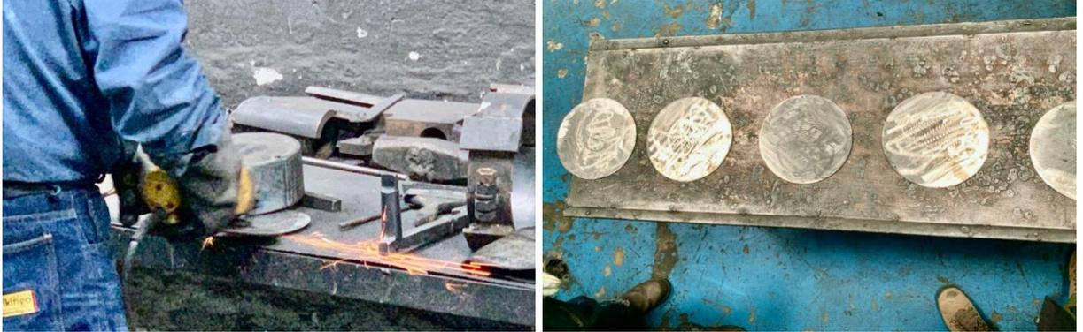
*Nota.* Láminas de acero esmeriladas con el disco de desbaste.
