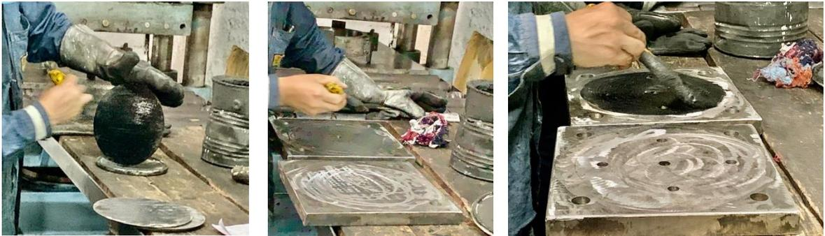
*Nota.* Recubrimiento de las placas de anclaje y láminas de acero con el pegamento CHEMLOK
