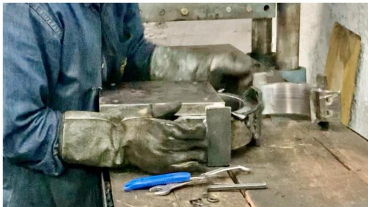
*Nota.* Desmontaje de los aisladores después del proceso de vulcanizado.
