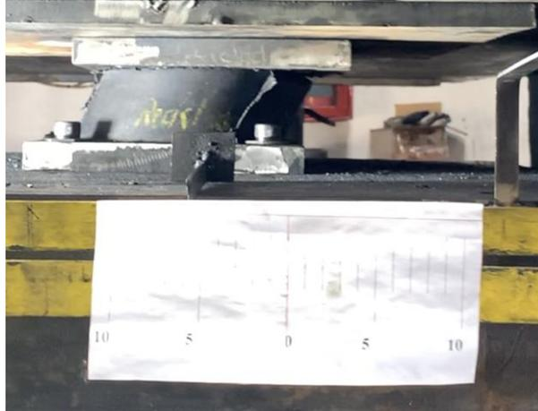
***Aislador sísmico elastomérico con material mixto 2 (virgen 40 % - reciclado 60 %).***
