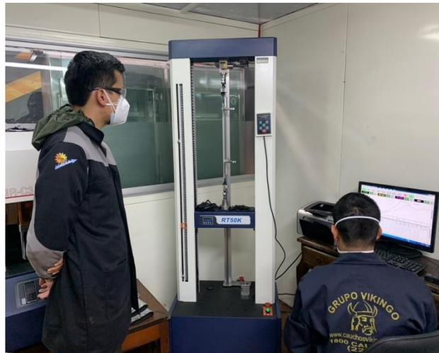
*Nota.* Ensayos de tracción de las probetas obtenidas con el elastómero mezclado.
