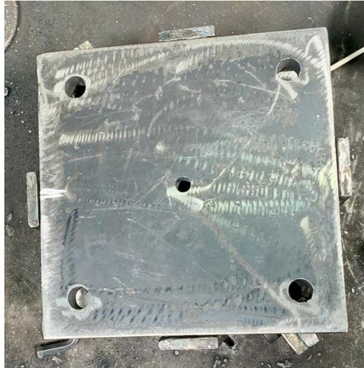
*Nota.* Placa de anclaje con 4 perforaciones de  $\frac{3}{4}$  (in) cada una.
