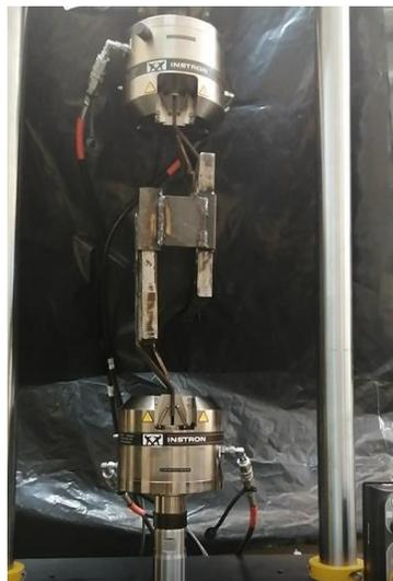
*Nota.* Ensayo del AEV1 sin carga a compresión en la máquina INSTRON 8801
