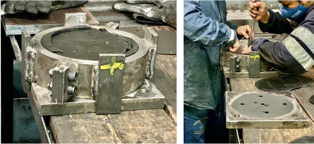
*Nota.* Montaje del aislador mediante la intercalación de las laminas de acero y el caucho.
