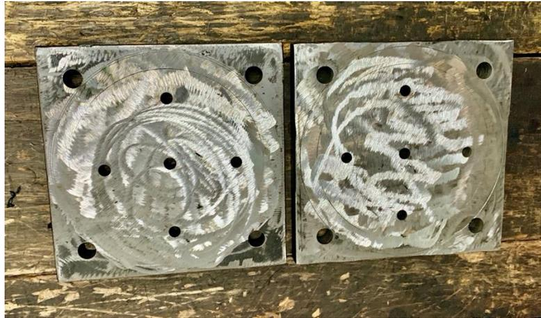
*Nota.* Placas de anclaje esmeriladas con el disco de desbaste.
