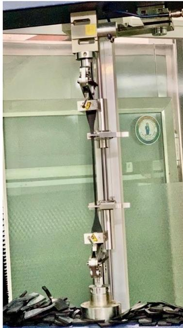
*Nota.* Ensayo de tracción hasta la rotura de las probetas elaboradas.
