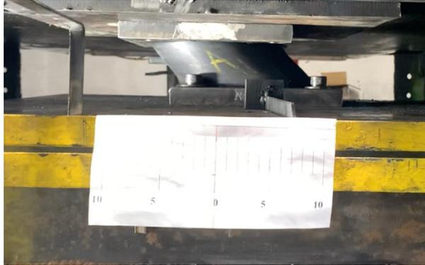
***Aislador sísmico elastomérico con material virgen 2.***
