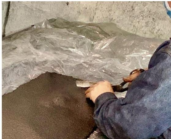
*Nota.* Extracción de muestras para la elaboración de probetas.
