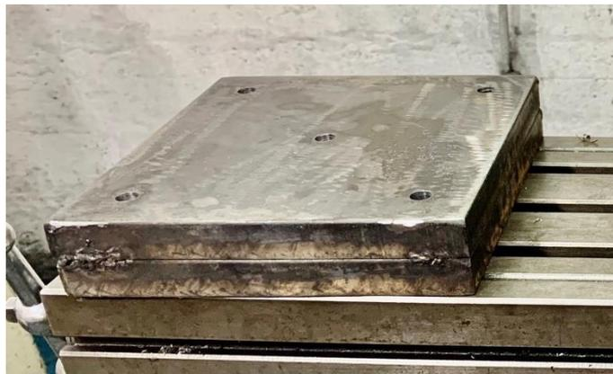
*Nota.* Obtención de 8 placas de anclaje en acero A36.
