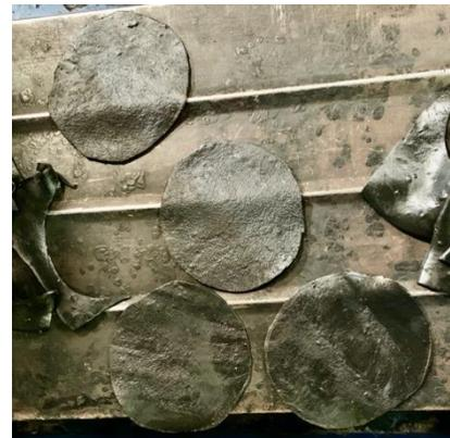
*Nota.* Corte del elastómero en círculos de 180 (mm) de diámetro.
