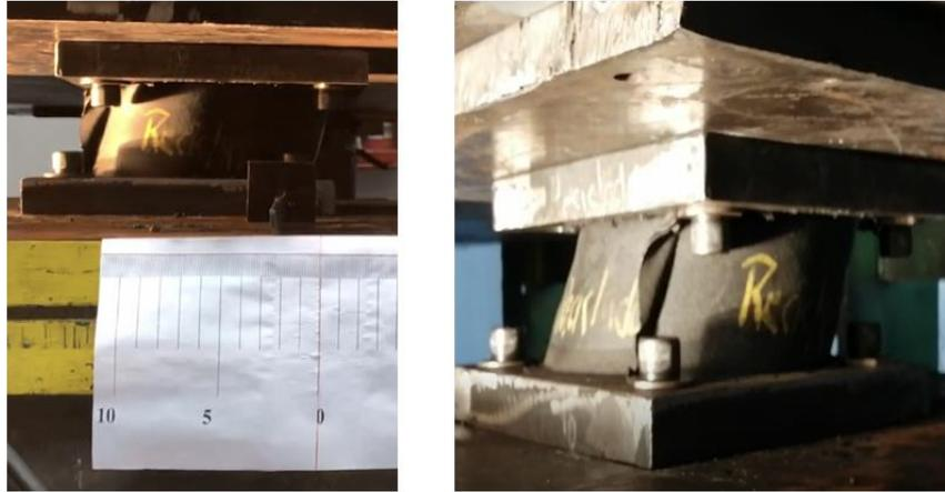
*Nota.* Ensayo sobre los aisladores reciclados al 50% del desplazamiento de diseño.
