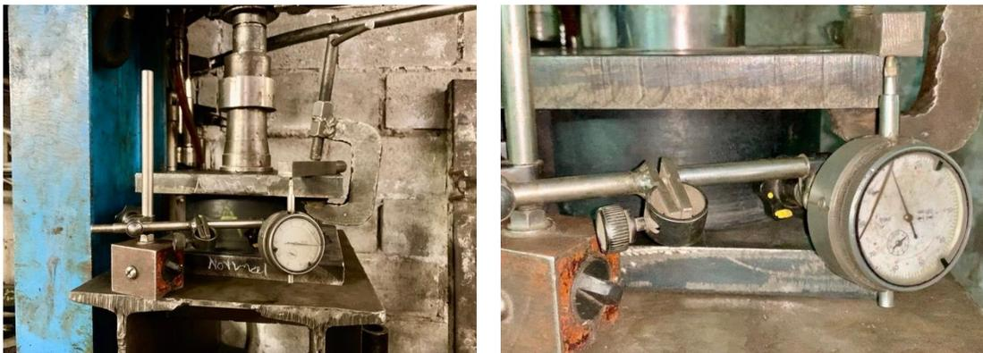
**Ensayos combinados de corte y compresión.**
