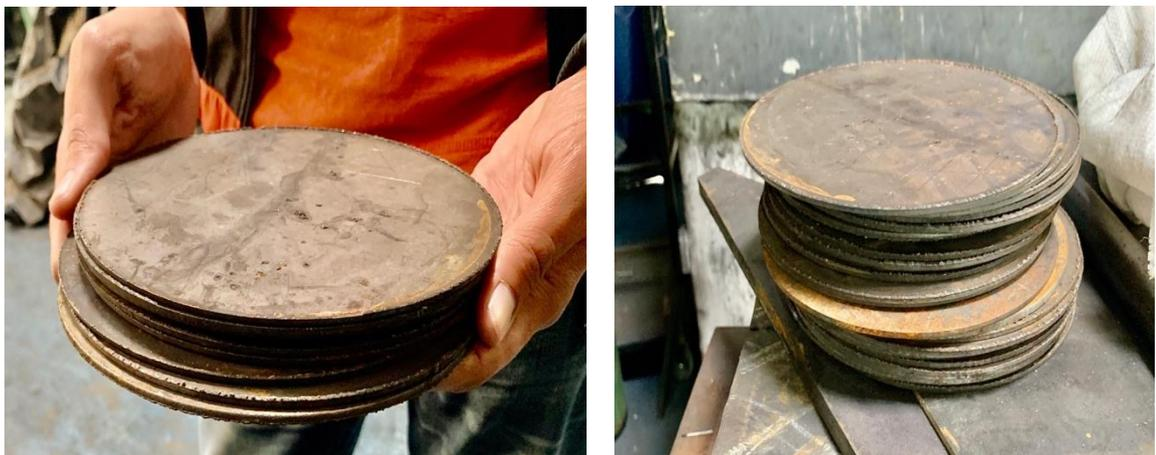
*Nota.* Láminas interiores de acero con un diámetro de 180 (mm) y 2 (mm) de espesor.
