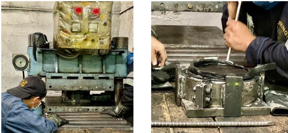
*Nota.* Compresión del aislador en la prensa para la verificación y relleno de vacíos.
