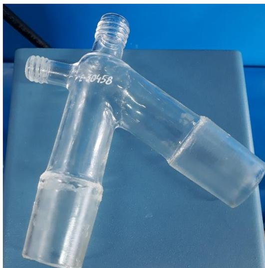
**Unión 2:** Es una alargadera que permite juntar la unión 1 con el condensador. Se puede observar en la figura 11.
