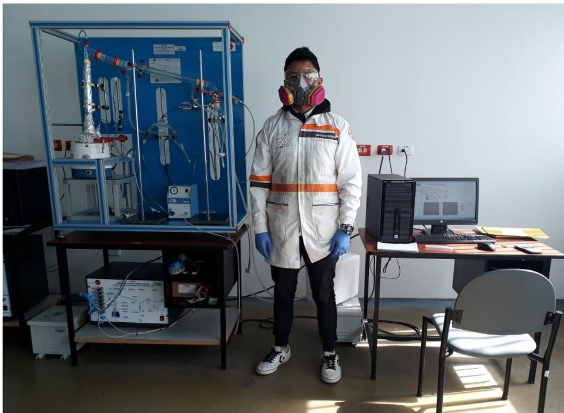
**Manta de calefacción:** Es una manta calefactora marca Boeco, opera hasta temperaturas de 450°C es adecuada y específica para un balón de 1L, el calentamiento es
