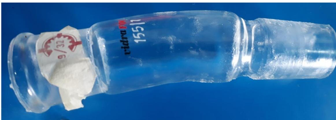
**Condensador:** El refrigerante es de tipo Liebig-West de diámetro de boca 29/32, el material presenta dos orificios laterales a la entrada y salida del agua de enfriamiento donde se coloca los últimos dos termopares del sistema.
