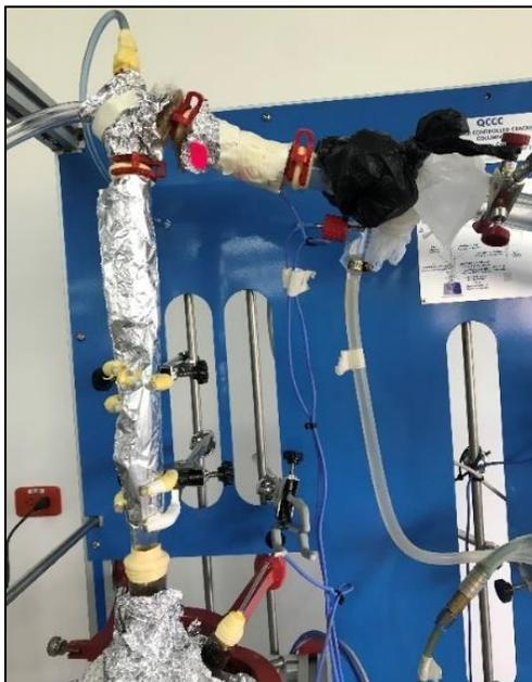
Finalmente, el Polipropileno fue fundido a una temperatura de 137 °C y se manejaron presiones entre -0,59 hasta -0,49 bar.
