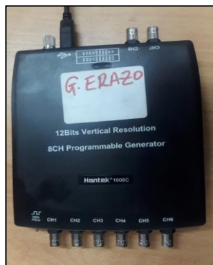
Figura 35. Osciloscopio Hantek 1008c
