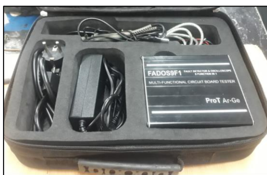
Figura 36. Detector de fallas y osciloscopio FADOS9F1
