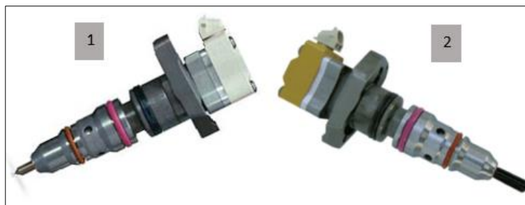
Figura 13. Inyector HEUI tipo B
