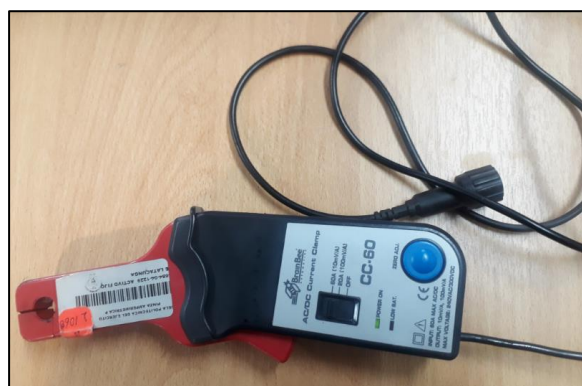
Figura 37. Pinza amperimétrica Brain Bee
