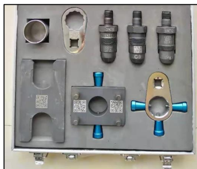
Figura 32. Herramientas para inyectores HEUI
