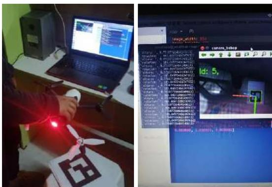
*Nota.* La gráfica muestra la detección de un marcador ArUco con el Parrot Bebop2, específicamente el ID:5. También se puede ver la estimación de pose del marcador con su respectivo sistema de coordenadas.
