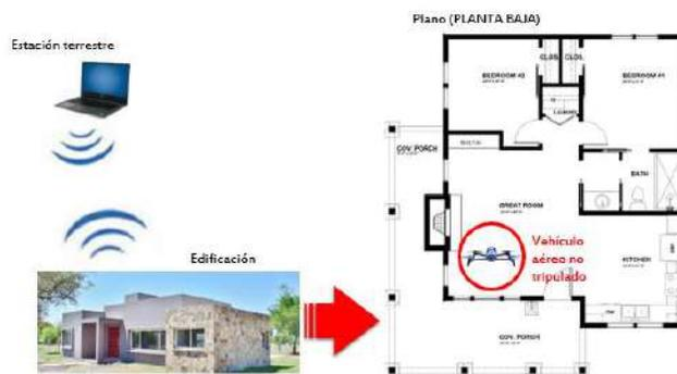
*Nota.* El gráfico muestra la estación terrestre y la edificación en donde el micro-UAV Parrot Bebop 2 realizará la planificación y seguimiento de trayectoria.
