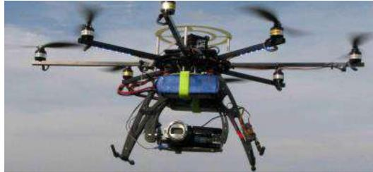
*Nota.* UAV multirrotores, configuración de 8 rotores. Tomado de “*DRONES: La tecnología, ventajas y sus posibles aplicaciones*”, (Pinto, 2016)
