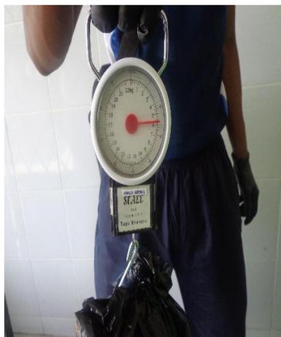
Instrumental con el cual se determinó el peso de los residuos
