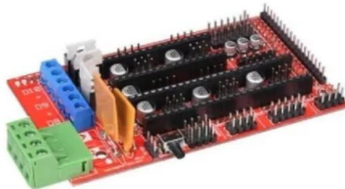
*Nota. En el gráfico se muestra una shield Ramps para Arduino Mega. (Shield Ramps 1.4 Controlador Impresora 3d Arduino Mega | Mercado Libre, 2021)*
