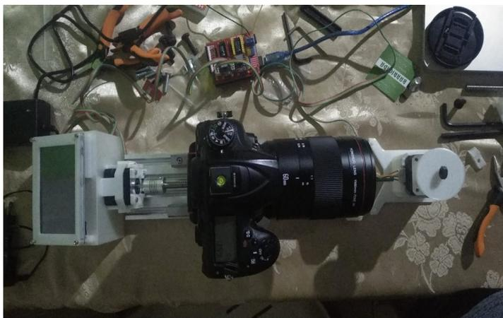
*Nota.* En el gráfico se muestra el ensamble de la parte mecánica.
