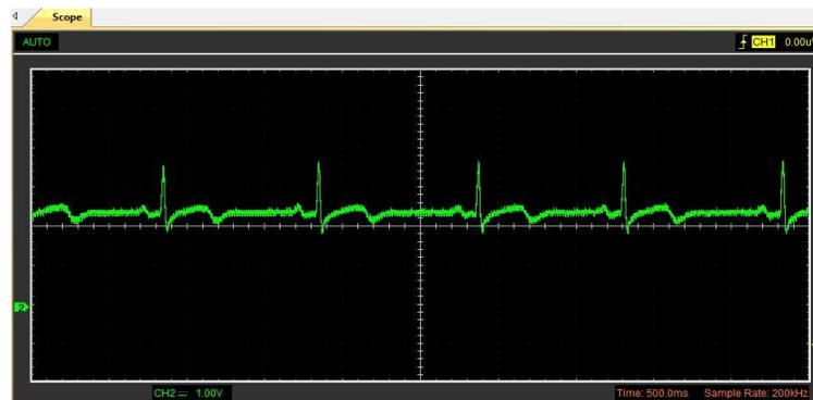
Como última derivación aumentada tenemos la AVF, que se puede visualizar en la Figura 110 donde la amplitud de la onda S disminuye significativamente y predomina la amplitud de la onda R.
