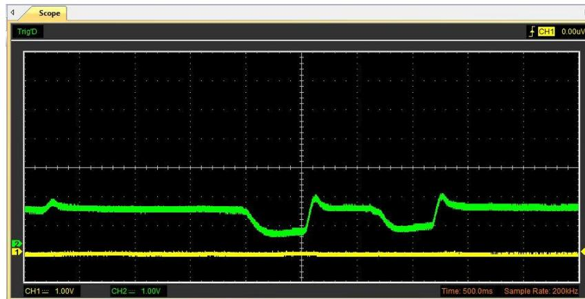
Se realizó pruebas para verificar el funcionamiento de las derivaciones horizontales, donde se realizó el movimiento de los ojos hacia la derecha y se pueden ver en la Figura 121.
