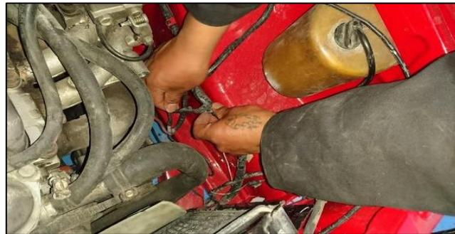
Armado del sistema de encendido.
