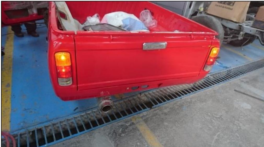
**Figura 57. Instalación de las luces de freno**
