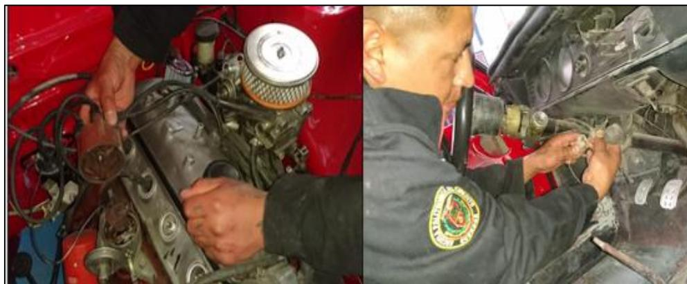
**Figura 43. Instalación del sistema de Encendido.**
