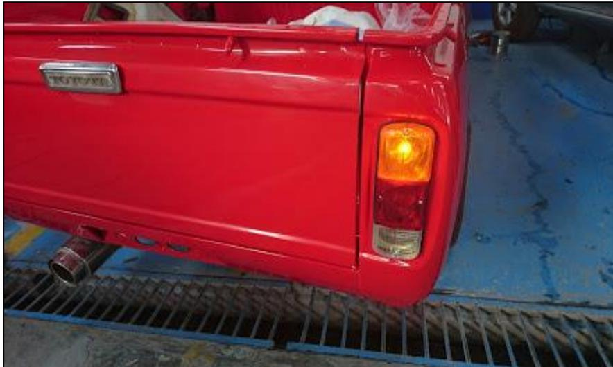
**Figura 55.** Instalación de las Luces Direccionales
