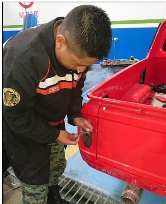
**Figura 53. Instalación de la luz de Reversa**
