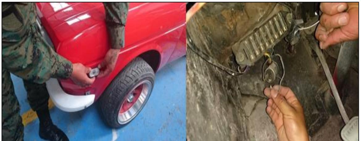
**Figura 59. Instalación de las luces de emergencia.**
