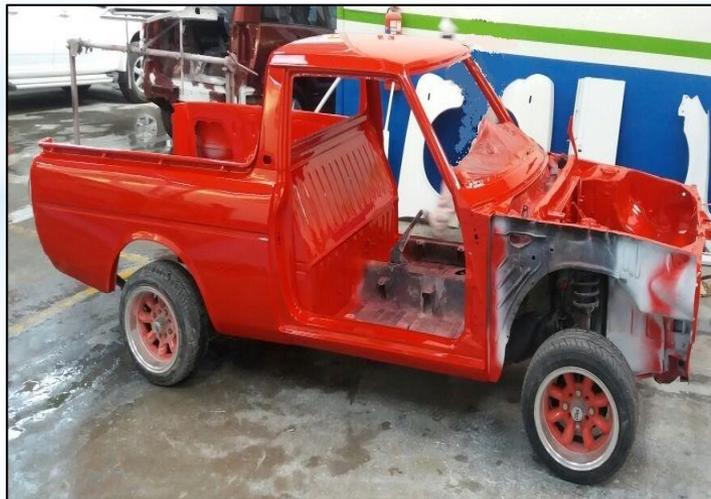
En primer lugar se desarmó todos los elementos eléctricos de la camioneta como son los faros delanteros, luces posteriores, cableado, accesorios, interruptores, fusibles, entre otros elementos para dar un tratamiento de pintura para completar con el arreglo de la camioneta Toyota 1000 del año 1973.
