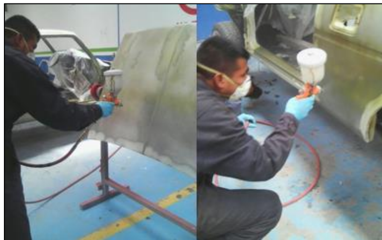
Figura 52. Aplicación del wash primer
