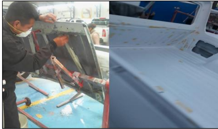
Figura 57. Aplicación de masilla rápida
