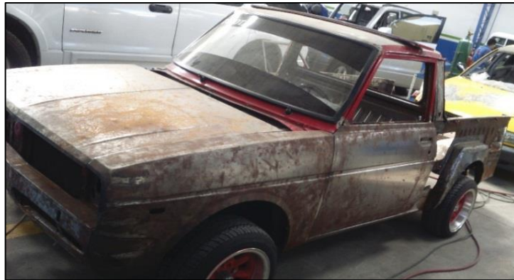
Figura 44. Decapado de la pintura
