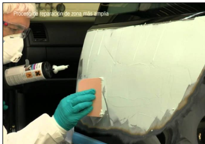
Figura 33. Aplicación de la masilla
