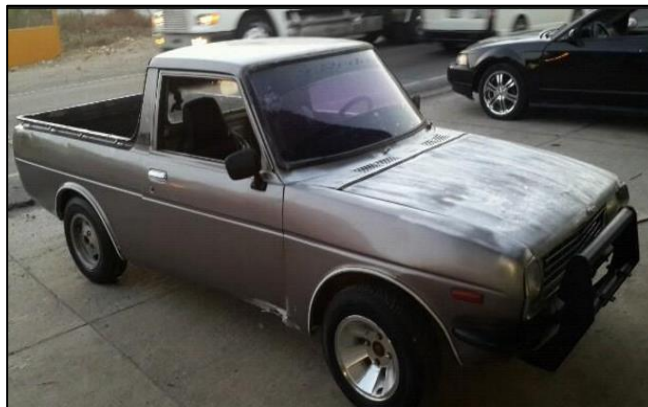
Figura 9. Corrosión del Vehículo
