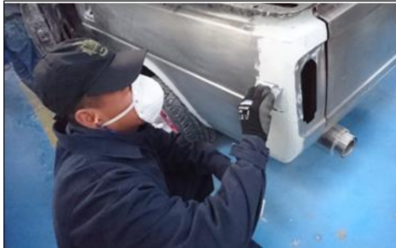
Figura 48. Aplicación de masilla
