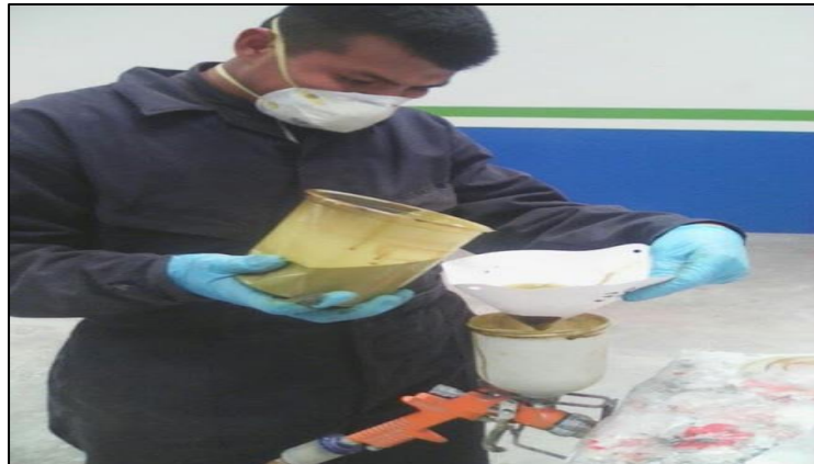
Figura 51. Preparación del wash primer
