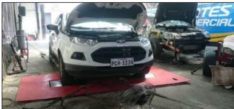
**Figura 25. Posición correcta del vehículo en el dinamómetro**
