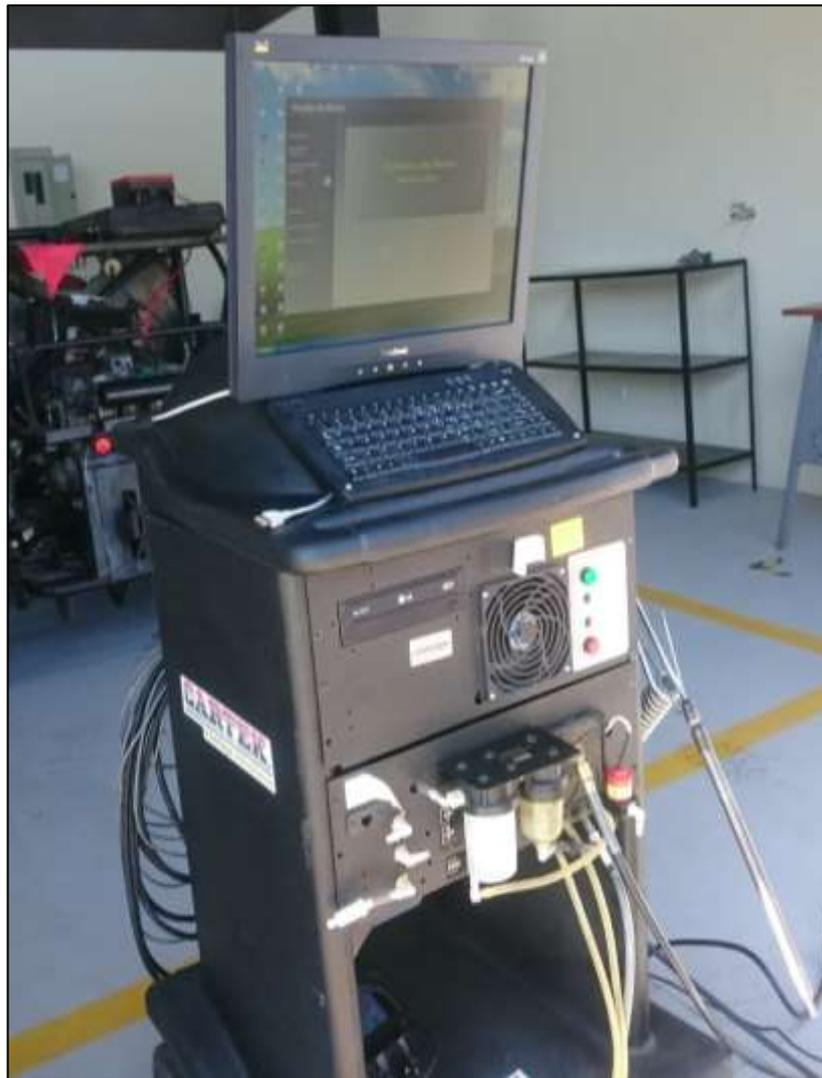
**Figura 32. Analizador de gases de la ESPE “CARTEK”**
