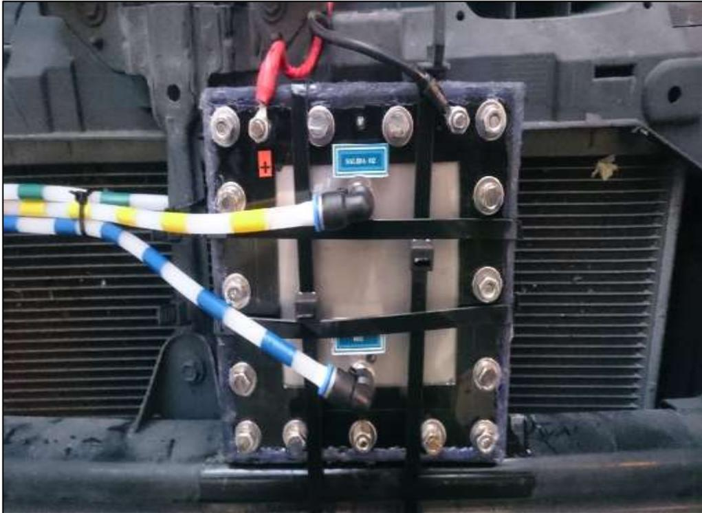
**Figura 20. Mangueras señaladas, acopladas y sujetas**
