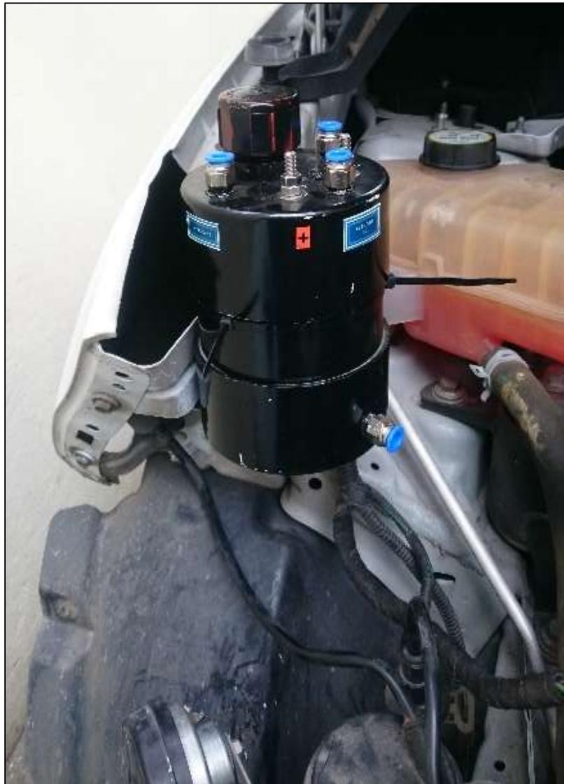
**Figura 19. Sujeción del depósito y burbujeador**
