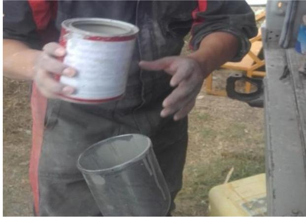
**Figura 46 Colocación de la pintura en la pistola**
