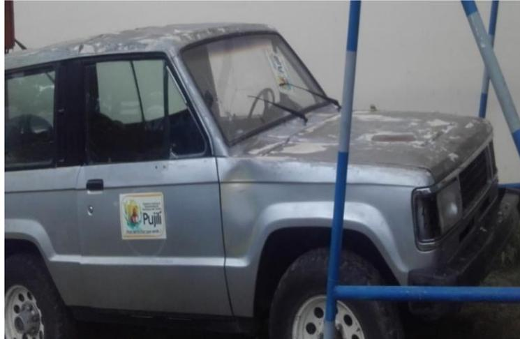
**Figura 25 Estado de la Carrocería previo a la reparación**
