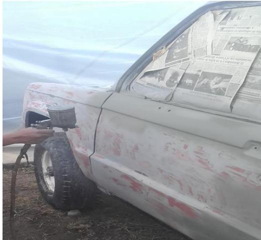
**Figura 43 Aplicación de las capas de fondo**
