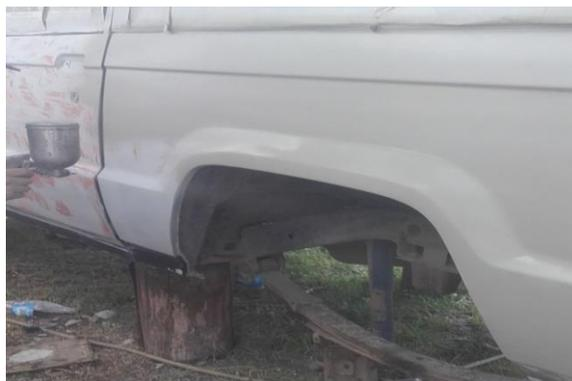
**Figura 47 Aplicación de pintura**
