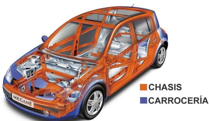
**Figura 1 Carrocería de un vehículo**
