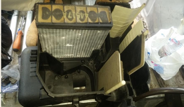
Radiador de calefacción
