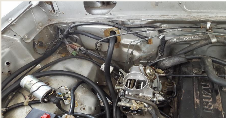
Cañerías de calefacción
