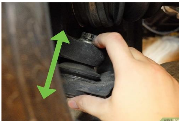
Figura 9 Bujes en mal estado
