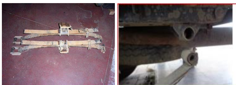
Figura 11 Desarmado de ballestas
