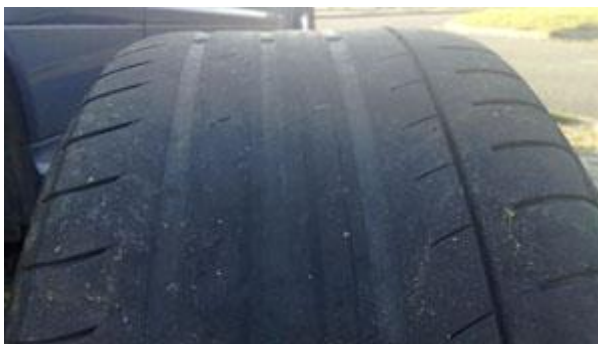
Figura 14 Neumáticos en muy mal estado
