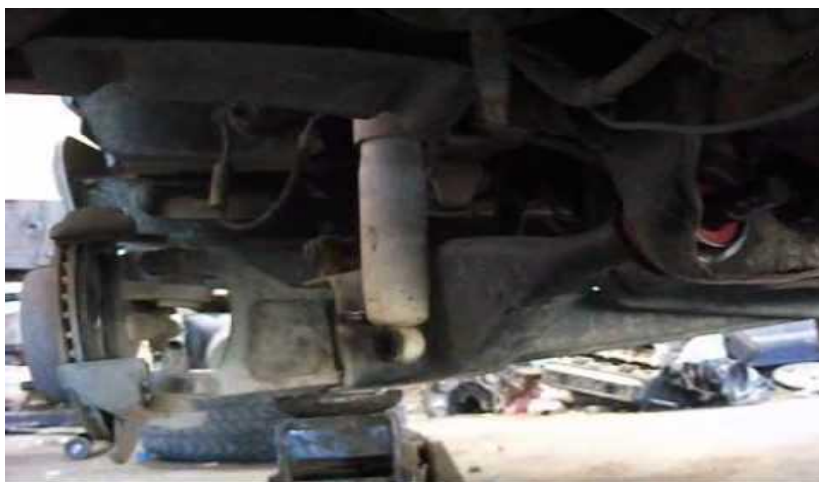
Figura 7 Desarmado del sistema de amortiguación
