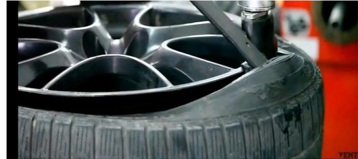
Para montar los neumáticos fue necesario usar una herramienta llamada continental ya q ayuda a meter el neumático en el aro, una vez metido en un lado del neumático ocupamos una cera parecida a la grasa que nos brinda mejor deslizamiento para que el neumático no se rompa al entrar en el aro, se coloca el tapón en la válvula del neumático y se procedió a inflarlo, el neumático se inflo aproximadamente con 35 libras para asfalto y terrenos duros.
