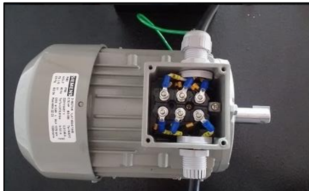
Figura 133. Motor trifásico conectado
