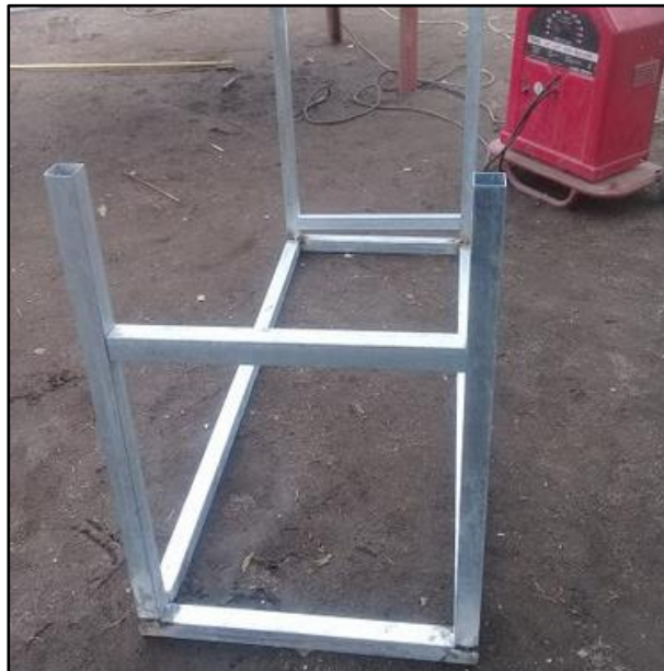
Figura 74. Tubos cuadrados soldados a 90^\circ
