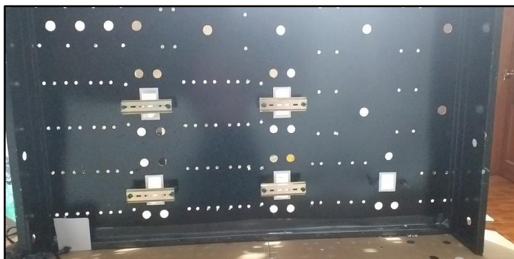
Figura 93. Riel din ubicadas en los pernos soldados
