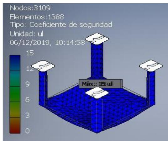
*Nota.* Software Inventor 2017 simulación de coeficiente de seguridad
