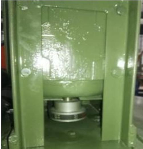
➤ **Unión de la base del motor con la base de las tapas**
