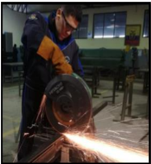
Corte de tubos estructural
