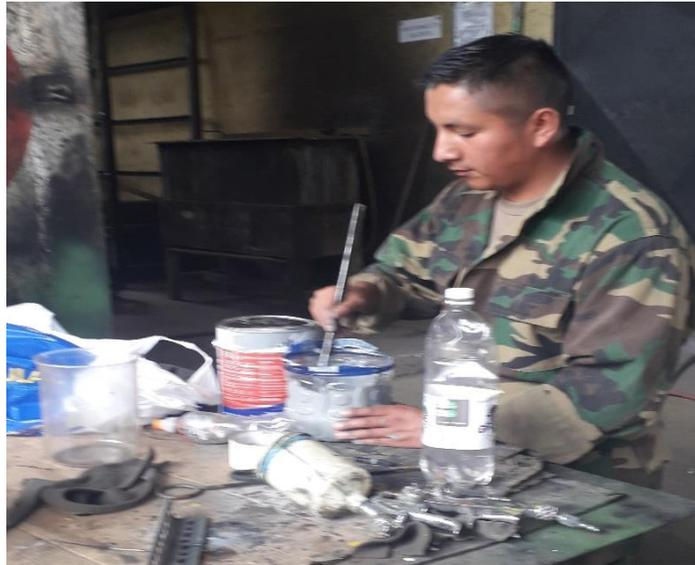
**Figura 35.** Preparación de pintura anticorrosiva.
