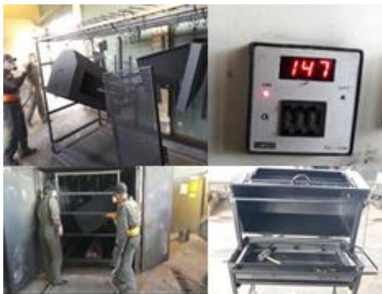
**Figura 37.** Prueba con pintura electroestática.
