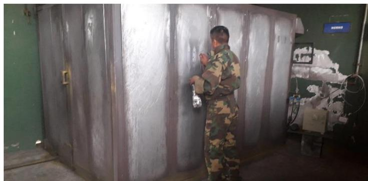
**Figura 34.** Eliminación de óxido del horno.
