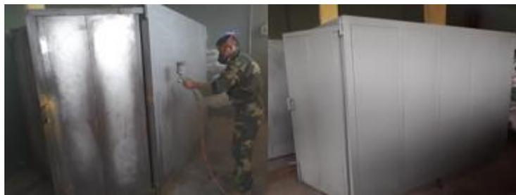
**Figura 36.** Proceso de pintado del horno.
