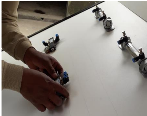
Figura 61. Colocación de la electroválvula
