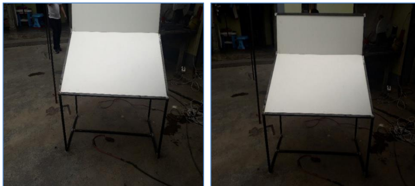
Figura 58. Colocación de MDF
