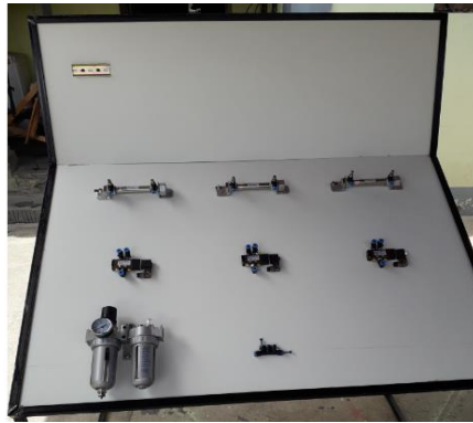
Figura 63. Colocación de la unidad de mantenimiento
