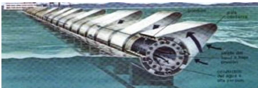
Figura 3. Generador mareomotriz de presa de marea
