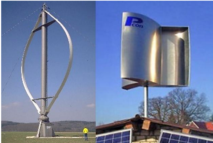
Figura 19. Aero generador vertical
