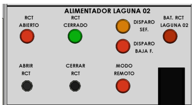
Figura 52 Conjunto de operación Alimentador Laguna 02
