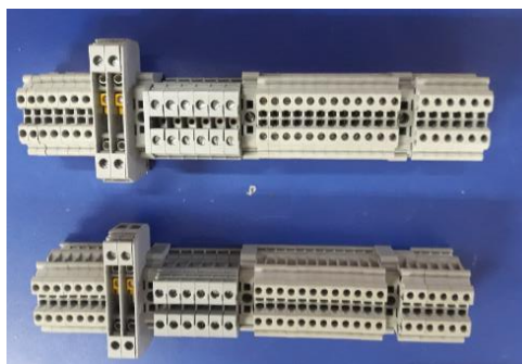
Figura 61 Bloques de borneras
