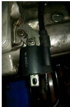
Figura 46 Instalación de la bobina
