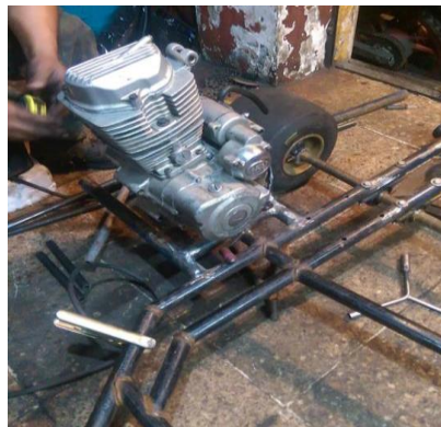
Figura 36 Base de motor
