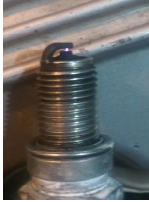
Figura 56 Salto de chispa en la bujía
