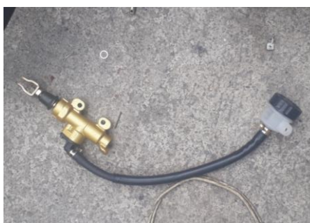
Figura 16 Depósito y Bomba
