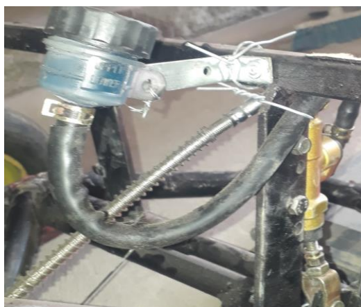
Figura 35 Adaptación del Pedal a la Bomba.
