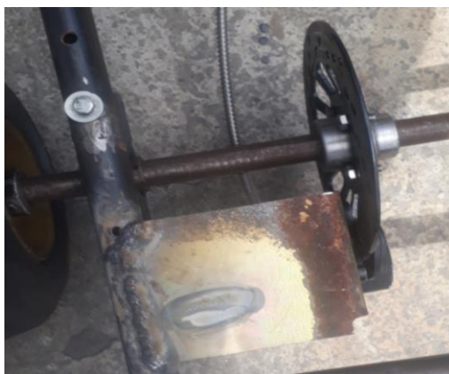
Figura 31 Mordaza de Disco de Freno Asegurada
