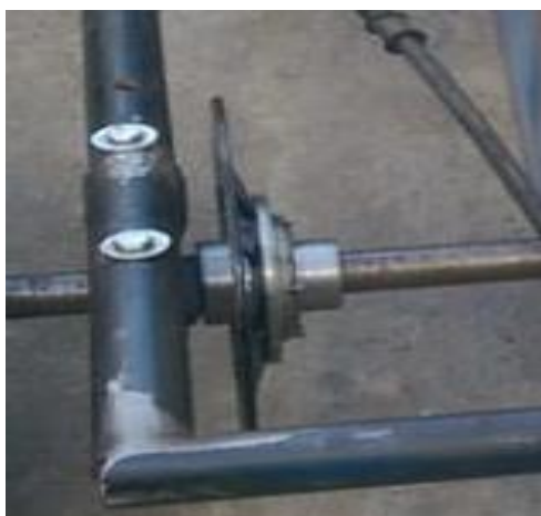
Figura 30 Anclaje de Disco de Freno al Eje.
