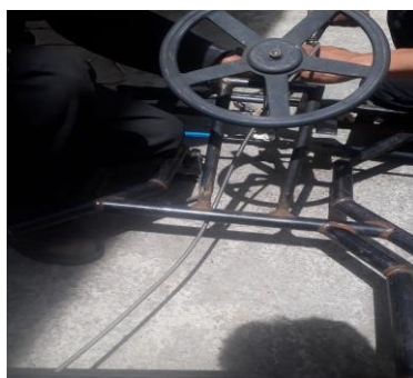
Figura 32 Colocación del Cable de Freno.
