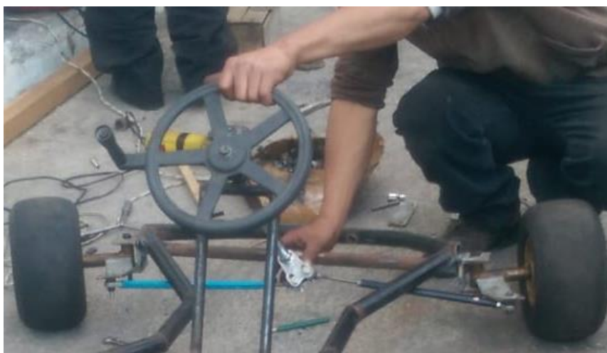
Figura 26 Colocación y Fijación del Volante.
