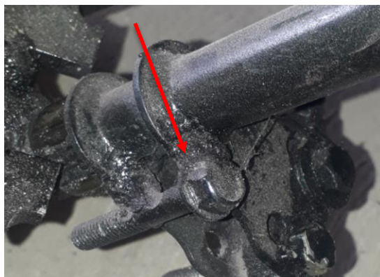
Figura 24 Soldada de Pernos Como Topes.
