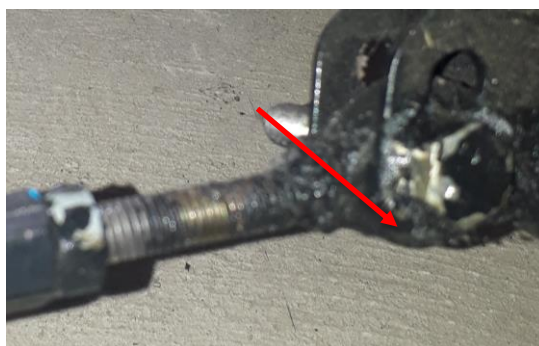
Figura 20 Punto de Suelda de Barra de Dirección.
