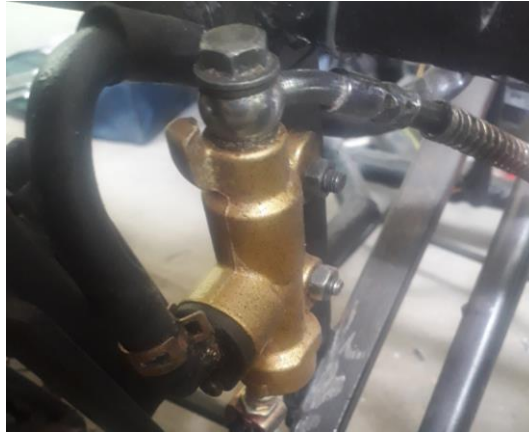
Figura 34 Fijación de Bomba a Depósito.
