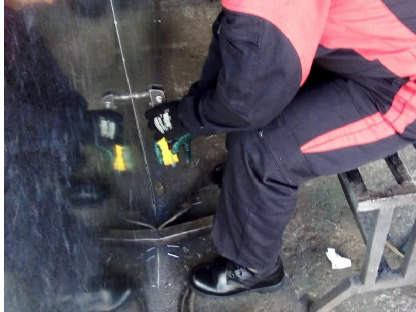
Figura 45 Fijación del forro exterior del furgón con remaches.
