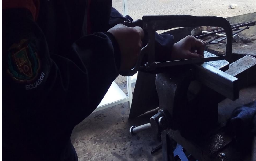
Figura 37 Proceso de corte de los tubos.
