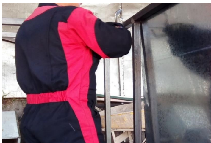
Figura 44 Colocación del forro exterior del furgón.
