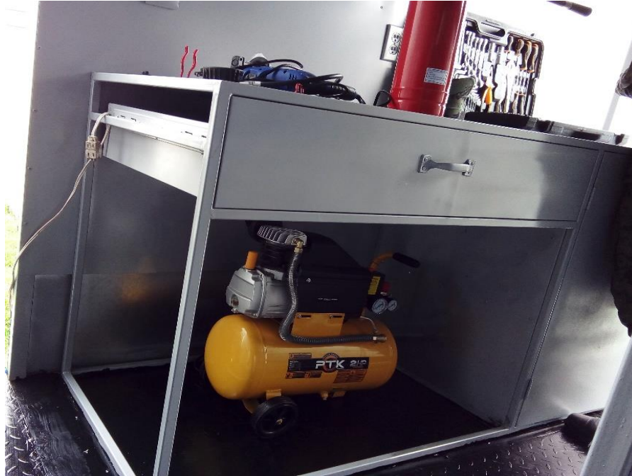
Figura 55 Compresor instalado en el furgón.
