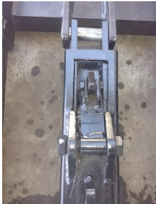
Figura 32. Sistema de seguridad colocado
