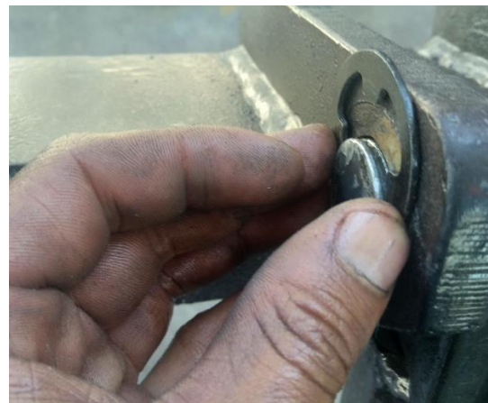
Figura 31. Colocación de los seguros del pasador
