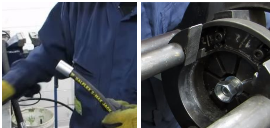
Figura 33. Remachado de ferrules y racores
