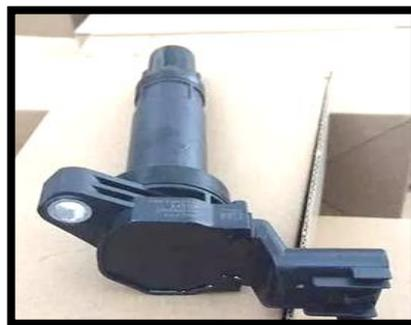
**Figura 20.** Bobina de ignición
