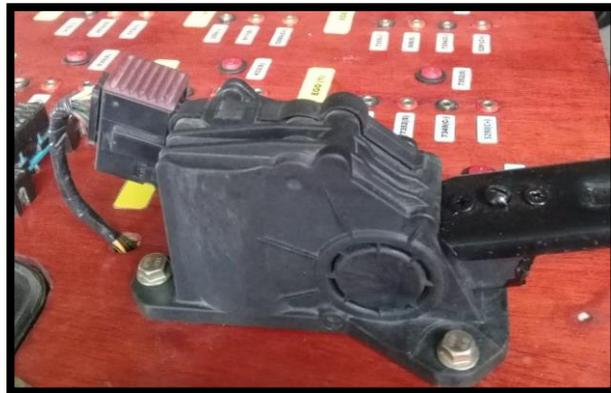
*Figura 18.* Sensor de posición del pedal de aceleración
