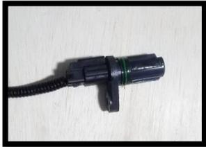
El sensor CKP no genera DTC en el scanner automotriz al instante de realizar el diagnóstico electrónico, debido a que la unidad de control electrónico asimila una avería siempre y cuando la señal del sensor CKP presente variaciones de voltaje de tensión relativamente altas o en su defecto muy bajas.
