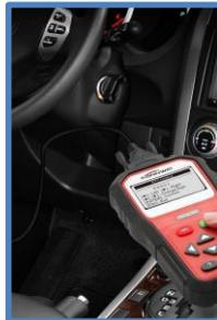
El sistema almacena un registro de la falla y las condiciones en las que se ha producido, designándole un código (DTC) para posteriormente pueda ser interpretado por un dispositivo de diagnóstico (Scanner)
