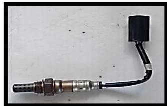
El sensor de oxígeno (EGO) delantero como posterior generan DTC aproximadamente a los 5 minutos que se interrumpe el circuito del elemento calefactor y de señal.
