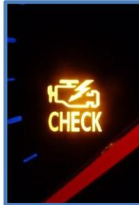
El OBD II controla el trabajo de cada uno de los sensores, una vez que alguno de ellos presente un comportamiento inusual, el sistema alerta al conductor con un sistema de lámpara denominado Check Engine
