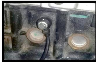
El sensor de golpeteo o detonación (KS) no generará dichos códigos ya que las interferencias eléctricas que se producen en el circuito son enviadas a la unidad electrónica de control y esta lo asimila como señales producidas por el sensor KS
